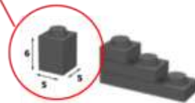
maó 1-1-1 (8 mm x 8 mm x 9,6 mm) 9,6 / 8 = 6 / 5 = 1,2 múltiple de 12 \rightarrow 9,6 \text{ mm} = 3 \times 3,2 \text{ mm}
